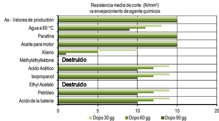
Las pruebas en las cuales no se especifica de otro modo, se efectuaron a 20 °C después de inmersión durante 30, 60 y 90 días a 20 °C sobre juntas de acero a acero, que se habían endurecido durante 48 horas a 20 °C.
