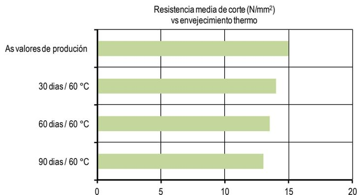
Las pruebas se efectuaron sobre juntas de acero a acero, que se habían envejecido a 60 °C.
