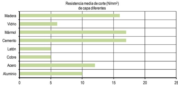
Las pruebas se efectuaron a 20 °C sobre juntas de metal a metal, que se habían endurecido durante 48 horas a 20 °C.
