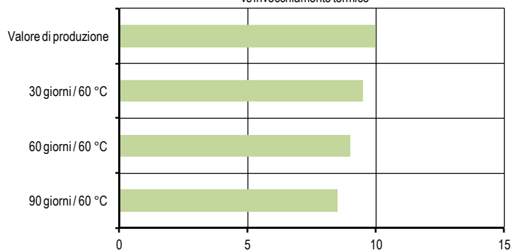
Resistenza media al taglio da sovrapposizione (N/mm 2 ) vs invecchiamento termico
