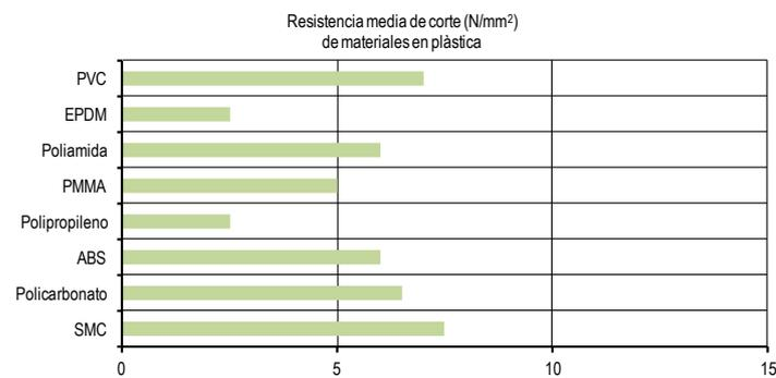
Las pruebas se efectuaron a 20 °C sobre juntas de plastica a plastica, que se habían endurecido durante 48 horas a 20 °C.
