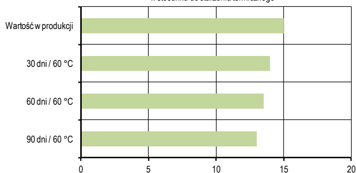
Średnia wytrzymałość na ścinanie (N/mm 2 ) w stosunku do starzenia termicznego
