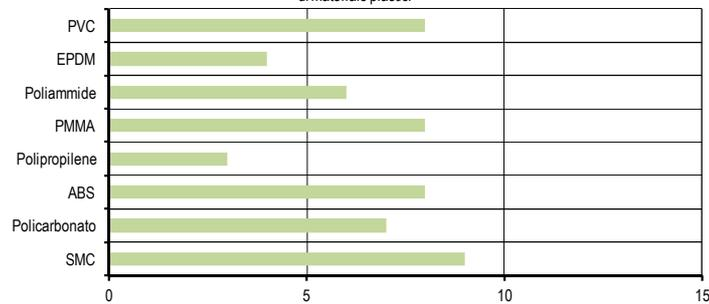
I test sono stati condotti alla temperatura di 20 °C su giunture plastica-plastica tipiche dopo indurimento di 48 h a 20 °C.
