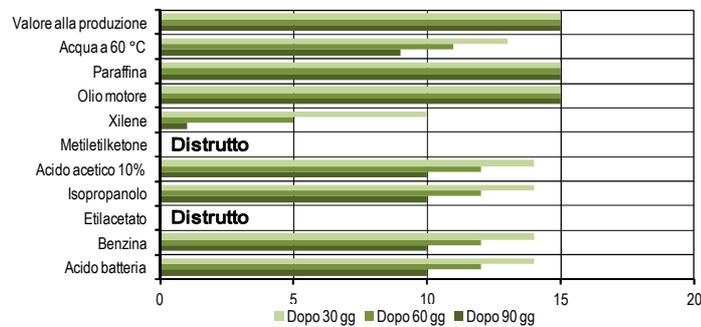
Ove non altrimenti indicato, i test sono stati condotti a 20 °C dopo immersione per 30, 60 e 90 gg a 20 °C su giuntura acciaio-acciaio tipica dopo indurimento di 48 h a 20 °C.
