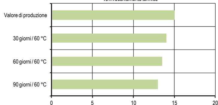
I test sono stati condotti alla temperatura di 20 °C su giunture acciaio-acciaio tipiche dopo invecchiamento a 60 °C.
