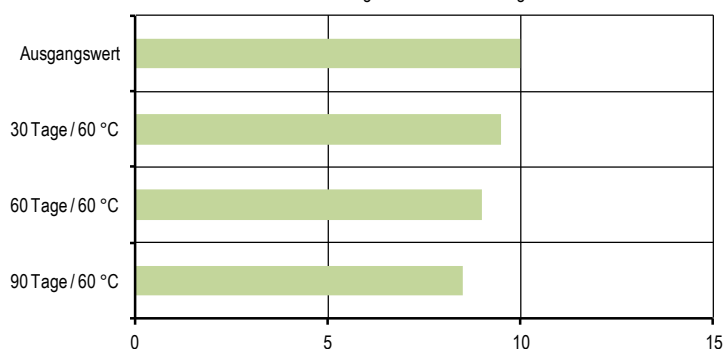
Durchschnittliche Scherfestigkeit bei Überlagerung (N/mm 2 ) bezogen auf Wärmealterung
