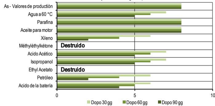
Las pruebas en las cuales no se especifica de otro modo, se efectuaron a 20 °C después de inmersión durante 30, 60 y 90 días a 20 °C sobre juntas de acero a acero, que se habían endurecido durante 48 horas a 20 °C.
