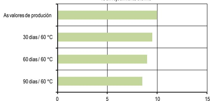
Las pruebas se efectuaron sobre juntas de acero a acero, que se habían envejecido a 60 °C.
