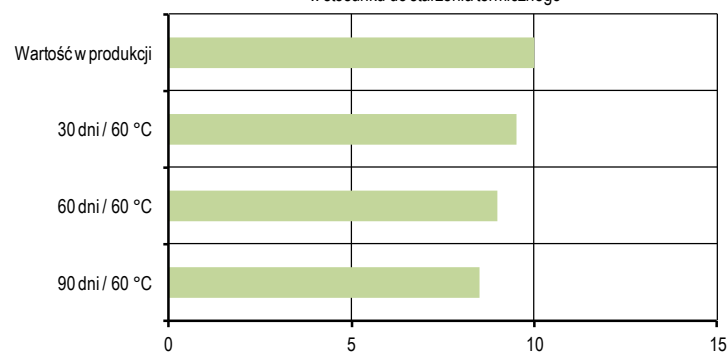
Średnia wytrzymałość na ścinanie (N/mm 2 ) w stosunku do starzenia termicznego
