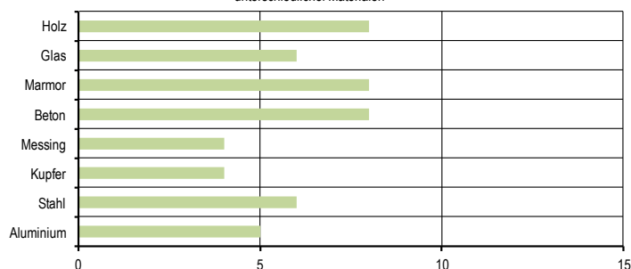
Durchschnittliche Scherfestigkeit bei Überlagerung (N/mm 2 ) unterschiedlicher Materialien
